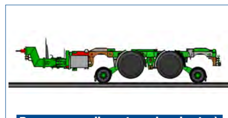
Remorque rail-route polyvalente à 3 bascules latérales - charge utile: 13,5 t / rail 19,5 t
