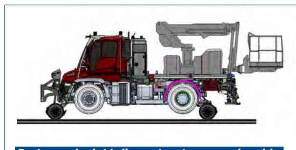
Porte-engin doté d'une structure remplaçable et d'une plateforme élévatrice
