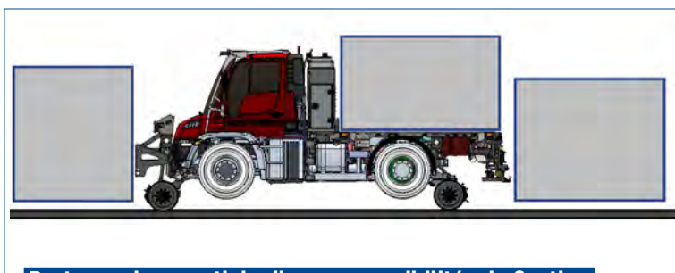
Porte-engin assorti de diverses possibilités de fixation de modules et d'engins
